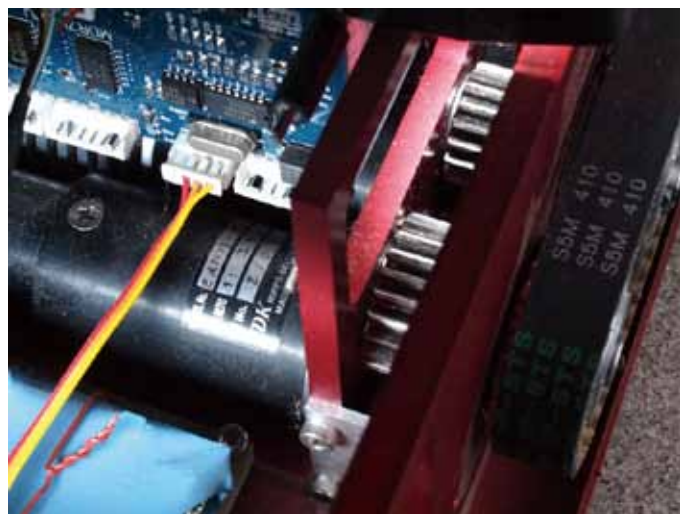
サブローラ駆動モーター。サブローラのモーター軸の外側をダンパーで覆っているので、強い衝撃を受けてもモーターへの影響が少ない
