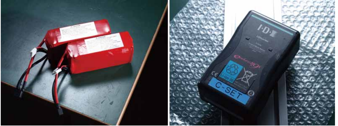
左がリチウムイオンポリマーバッテリー（「Kenaf」で使用）と、リチウムイオンバッテリー（右・「Quince」で使用）
