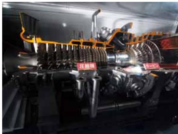
ガスタービンを構成する3要素のうち、圧縮機に関しても、様々な技術開発が行われました。ガスタービンの性能を向上させるには、燃焼に使う空気の圧力比を高めることも重要です。圧力比とは、圧縮前と後の空気の圧力比率のことです。圧縮機に取り付けられた翼を使ってより多くの空気を圧縮機内に取り込み圧縮していくことで、圧力比を高めることができます。
