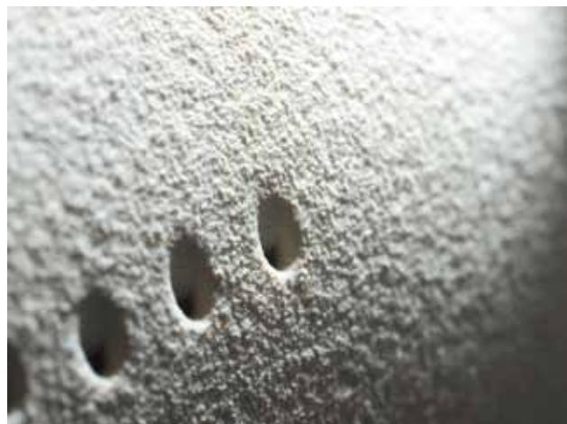
三菱重工業は、さらに遮熱コーティング技術も開発しました。これは、熱伝導率の低いセラミックスを翼の表面に吹きつけ、コーティングすることで、翼を高熱から守ろうというものです。1986年に実用化した「1,250°C級 MF111形」から採用されました。MF111形は、当時の発電用としては世界最高のタービン入口温度を達成しました（図6）。
