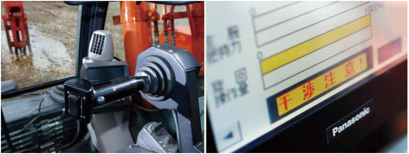
実際の右腕用操作レバー（左）、コントロールパネルに表示される干渉警告（右）（写真は ASTACO NEO のもの）
