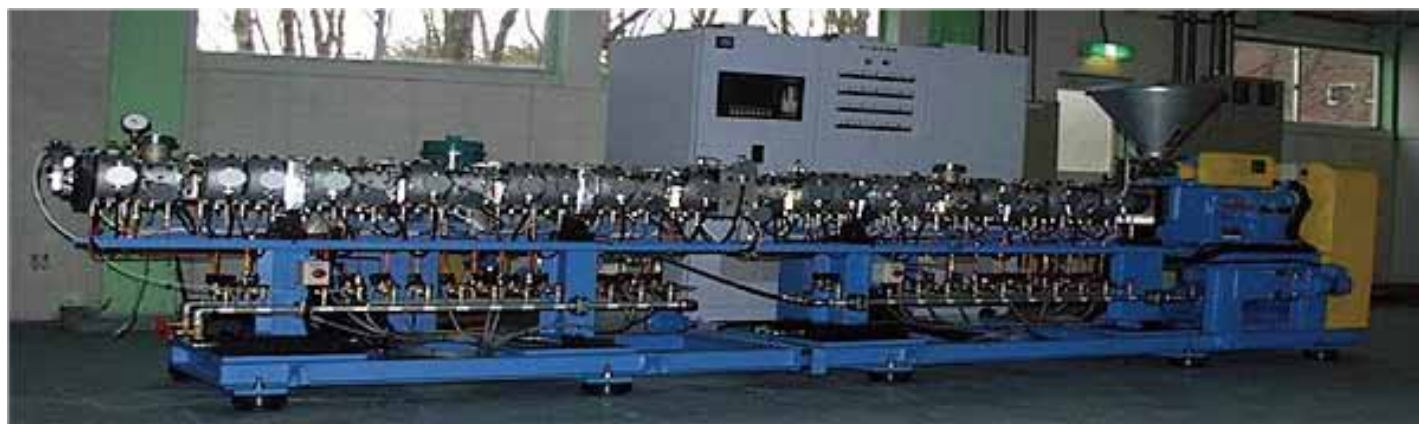
ナノミセル型ポリマーアロイのために作られた二軸押出機「MOMOKO」。 従来の押出機より長い時間かけてじっくり練ってアロイ化する
