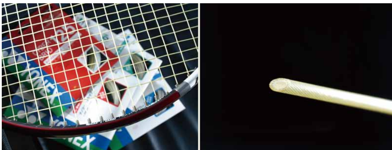
衝撃吸収ナイロンを使用したテニスラケット用ストリング（左）。その断面（右）。灰色の円形部分が衝撃吸収ナイロン
