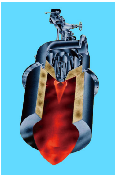
図 2 ボルテックスバーナーの構造図（左）とその特色（右）
