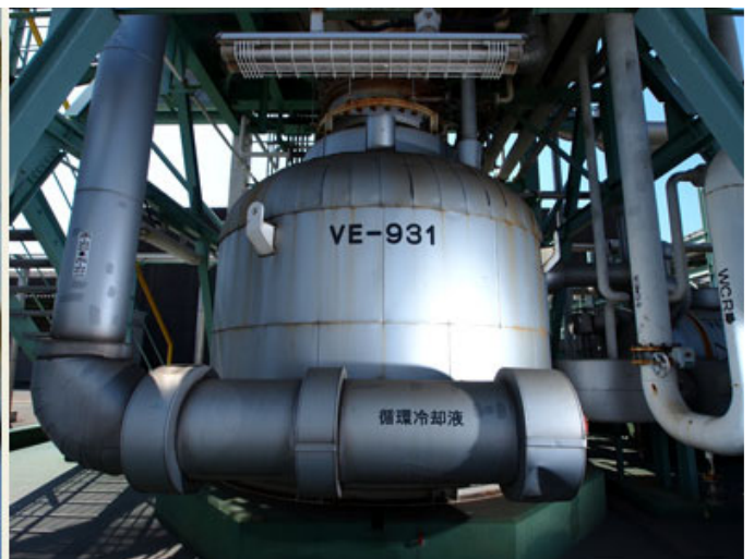
図3 冷却缶での液中燃焼法。一気に急冷することでダイオキシン類の再合成もない
