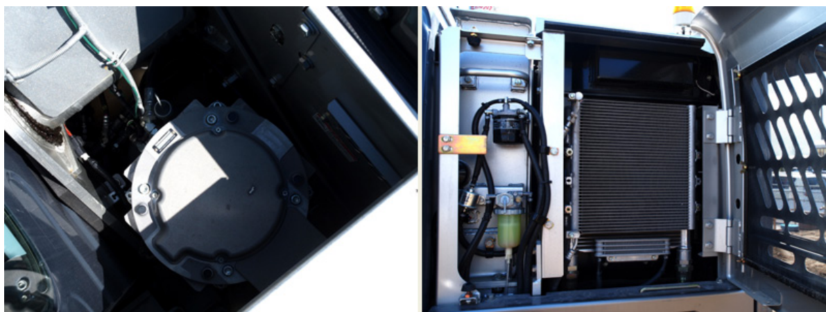
旋回用モーター（左）、エンジン小型化でサイズの小さくなったラジエーター（右）
