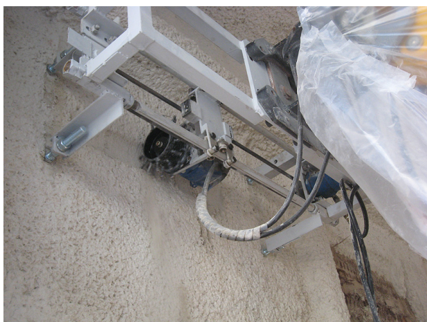
3回目に開発した「横行装置組み込み型回転ブラシ方式」のアタッチメント
