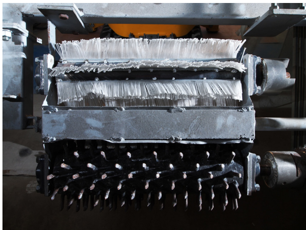
ついに完成形へたどり着いた円筒型アタッチメント。 下部が粗削り、上部が仕上げ用
