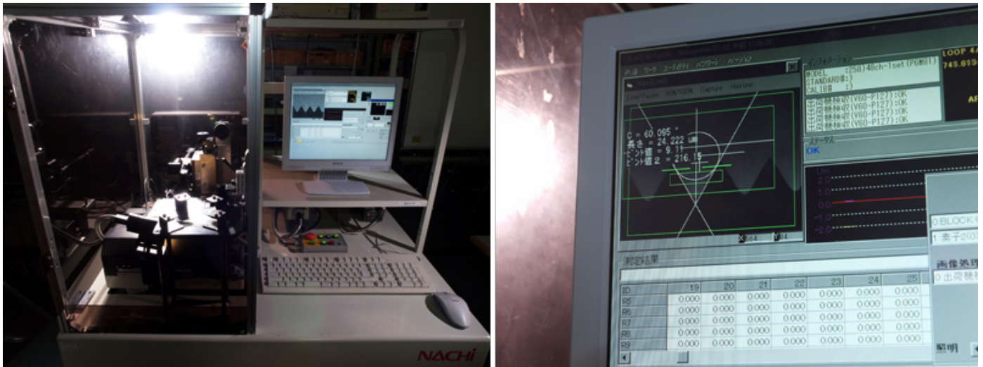
画像処理装置（左）とそのモニタ画面（右）。
