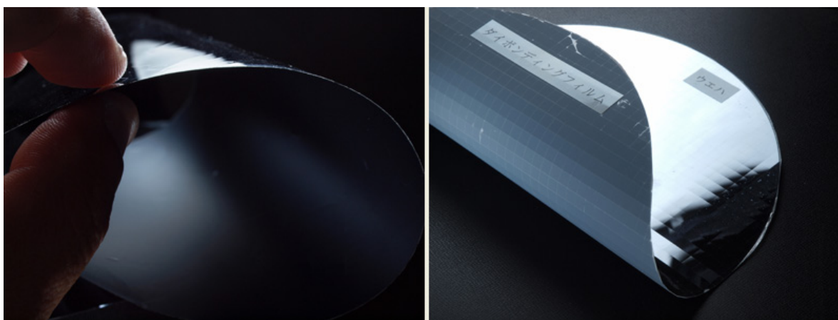
厚さ 30mm の半導体ウエハ (左の写真) と、それに貼り付けられたボンディングフィルム (右の写真)
