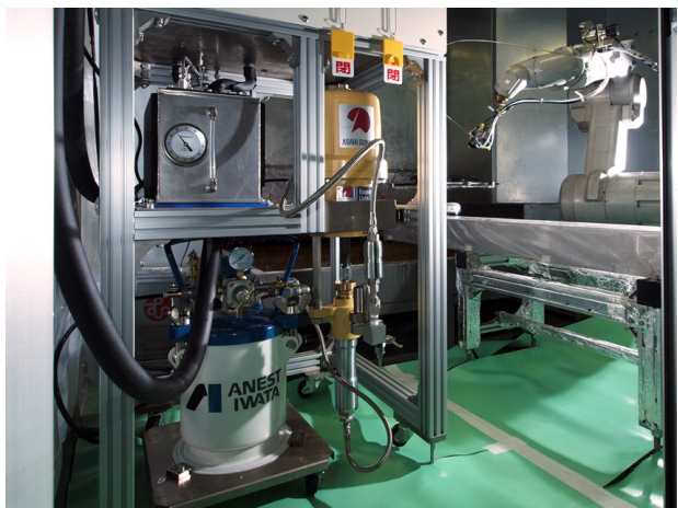
吹き付けユニットの塗料タンク
