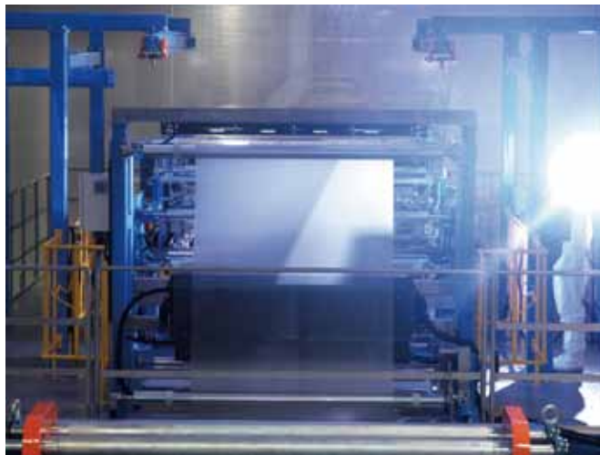
押出、延伸、貼り合わせの工程を終えて完成した光学フィルム
