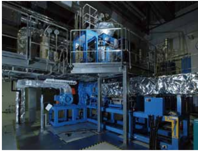
富山県氷見市にある日本ゼオンの光学フィルム製造子会社オプテスの工場にある溶融押出成形機
