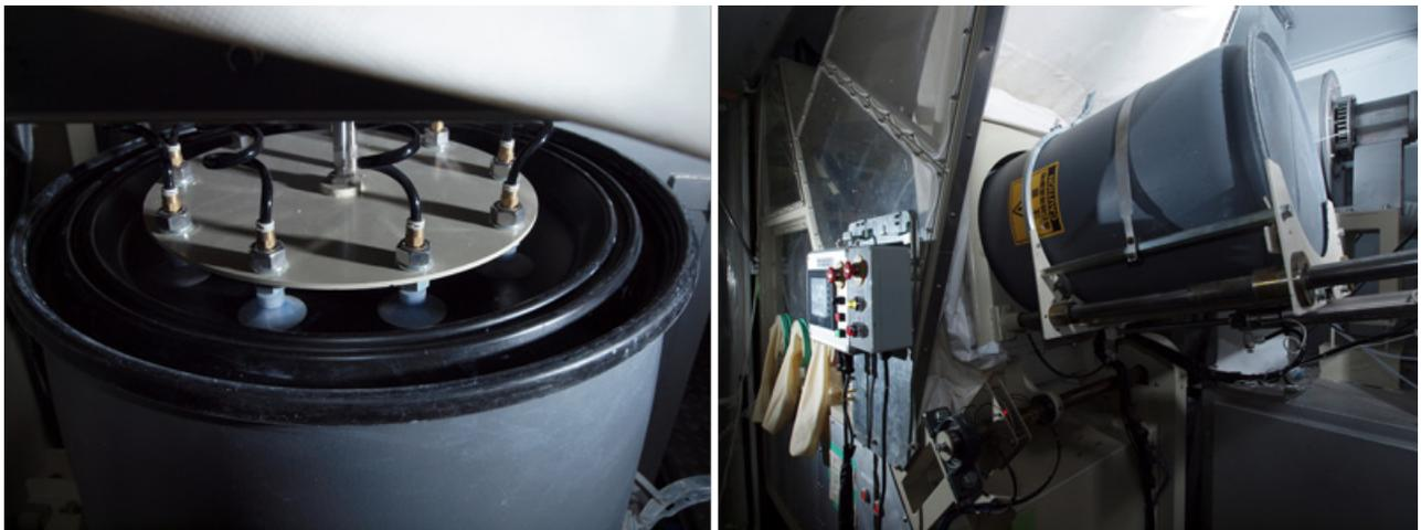
処理前の保温材は密閉性の高い容器(左)に入れられて、トレーラーの中で容器を投入装置にセットすることで安全に処理システム内へ投入されていく
