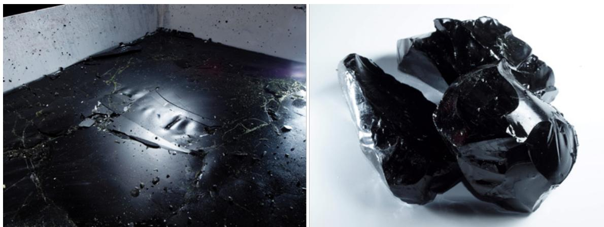
保温材が完全に溶融した後冷え固まった状態で装置から排出されたガラス状の溶融物（左）、
