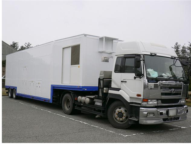
オンサイト式アスベスト溶融・無害化処理システムを搭載したトレーラー。このトレーラー内で無害化処理が可能
