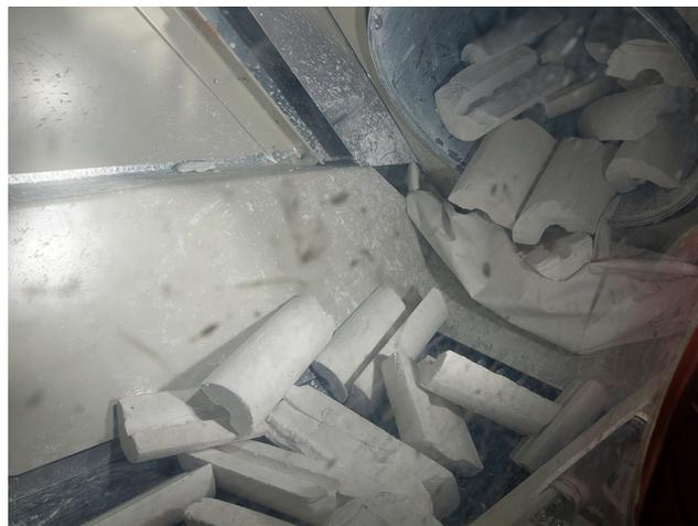
処理システムに投入された配管用保温材。
