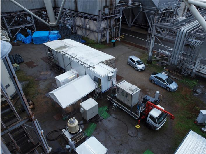
富山新港火力発電所内に設置されたトレーラー。前部のトラックには誘導加熱溶融炉の電力を制御するインバータが搭載されている
