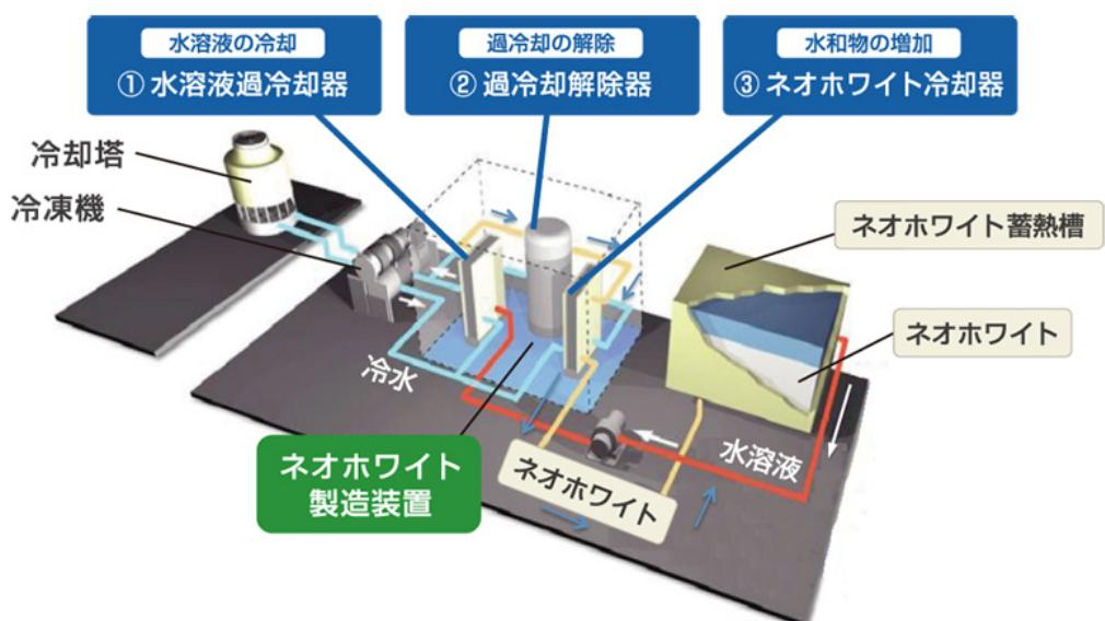
図4 3段階の装置による水和物スラリ製造。水溶液過冷却器、過冷却解除器、ネオホワイト冷却器の作動順
