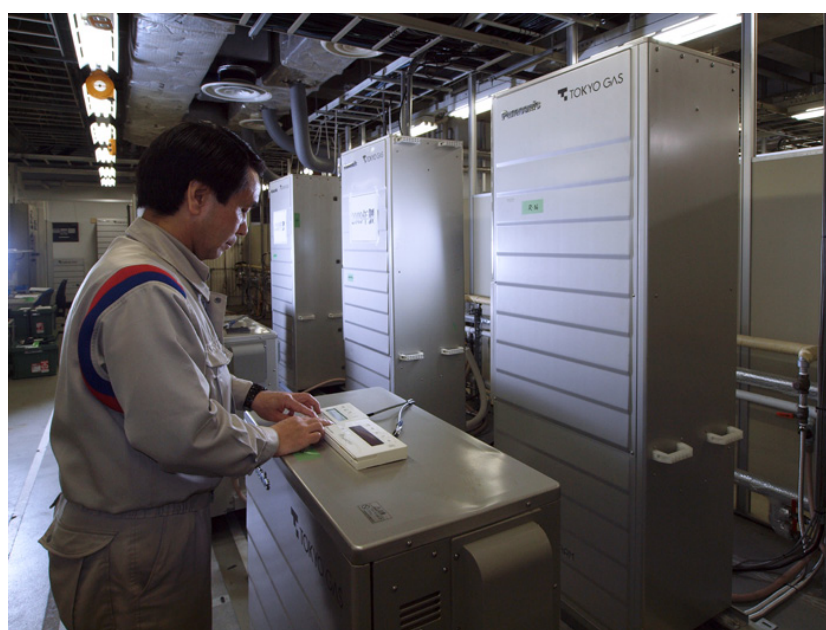
エネファームのシステム評価試験
