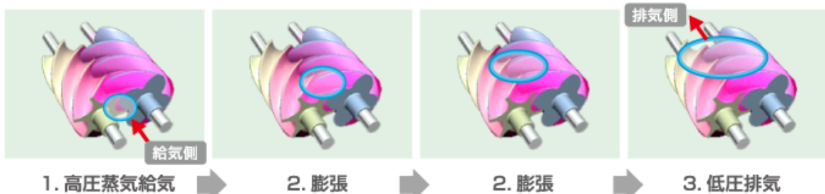
図6 スクリューが回転する仕組み
