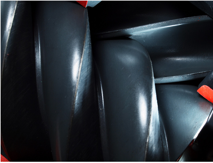
オスローターとメスローターの非接触の隙間はミクロン単位で加工
