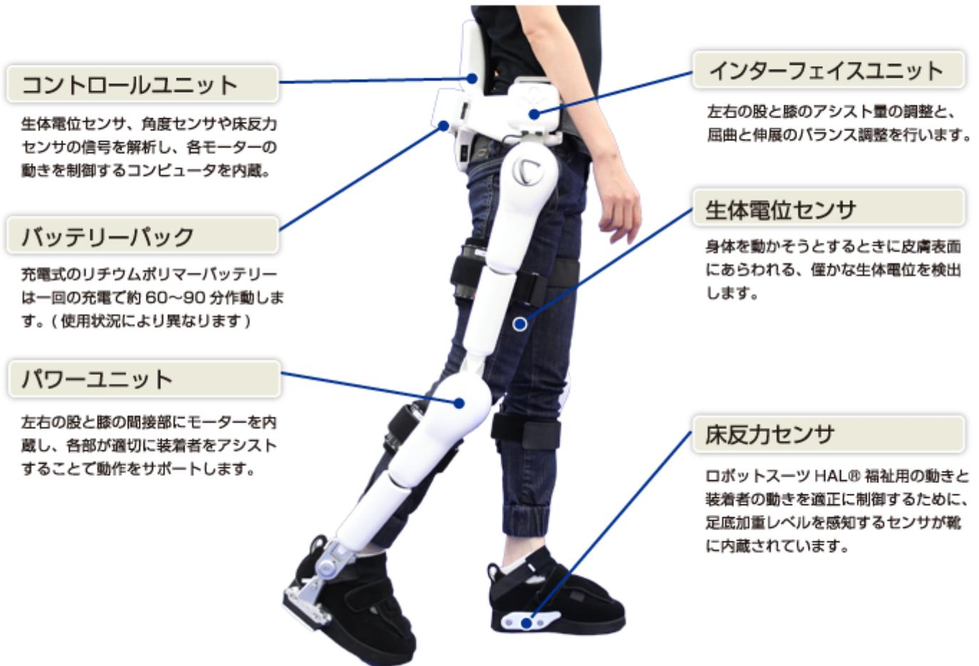
図1 ロボットスーツ HAL® 福祉用の装着例と各部名称。脚力が低下した人や、病気・怪我などで下肢の運動機能に障がいがある人が身につける第2の骨格のようなロボット。両脚モデル（写真）で11kg、単脚モデルは6kg。本体が床面に設置して重量を支える構造になっているため、身に着けた人が重みを感じることはない
