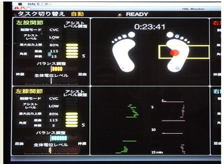
腰部のインターフェイスユニット(左)、これらのボタンでアシストレベルを微調整し、装着者にあわせる。歩行の改善が見られれば、アシストレベルを下げる。トレーニングはアシストレベルをモニター(右)で確認しながら行われる
