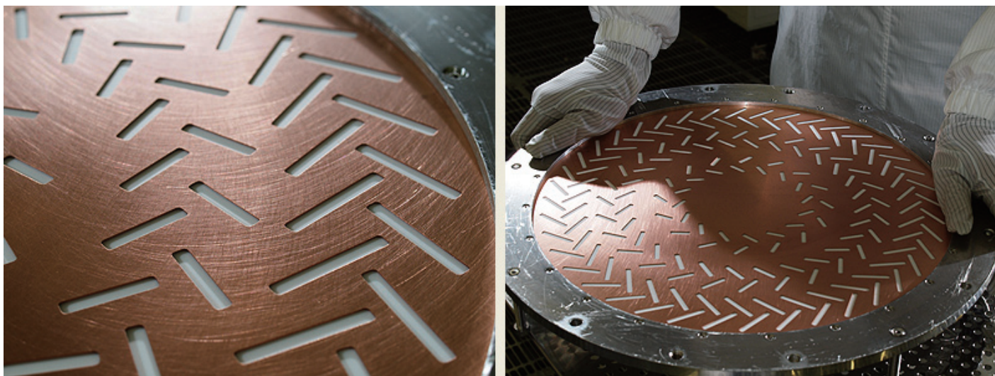
刻み込まれたスロットが特徴的な、ラジアルラインスロットアンテナ
