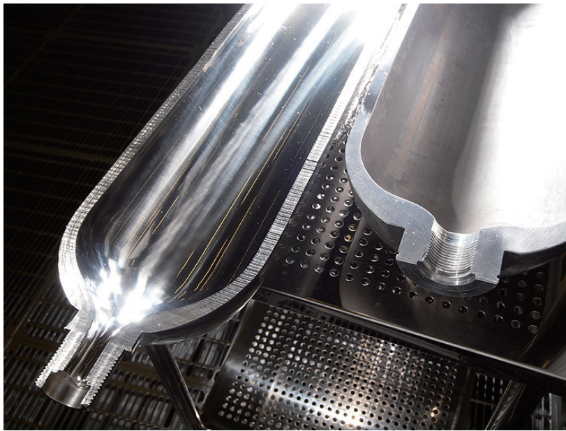
内表面が電解複合研磨によって磨かれたウルトラクリーンポンペ（大見研究室）
