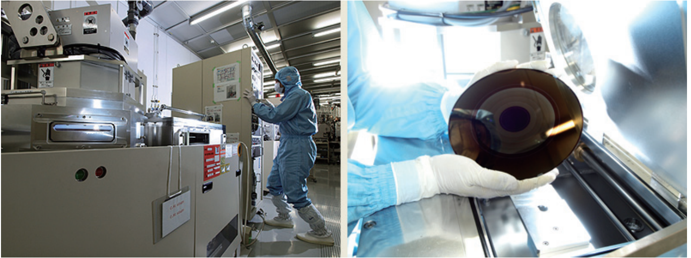
ドライエッチング装置（左）とエッチングの終わったウエハ
