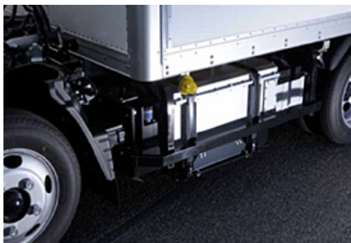
箱状の容器に取められたキャンターエコハイブリッドのリチウムイオン電池
