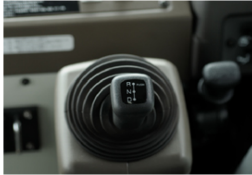
エアロスターエコハイブリッドのメーターパネル。中央に大きくバッテリー残量計がある (左) エアロスターエコハイブリッドのシフトレバー。モーターで走るため、前後進だけを選択する (右)
