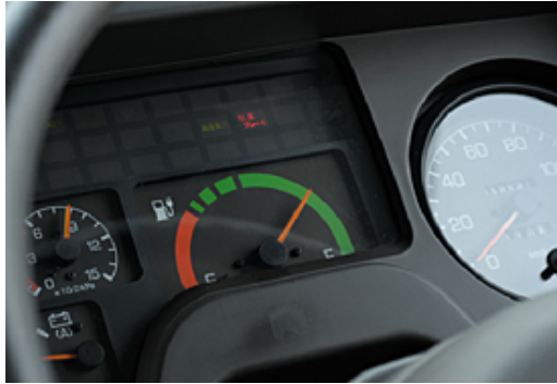
エアロスターエコハイブリッドのメーターパネル。中央に大きくバッテリー残量計がある (左) エアロスターエコハイブリッドのシフトレバー。モーターで走るため、前後進だけを選択する (右)
