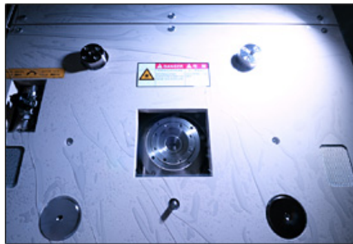
中央の円形部分から微細加工用のレーザーが発振される
