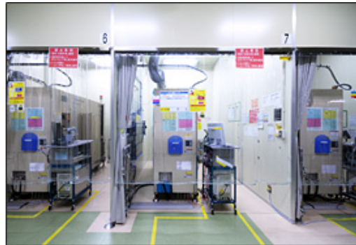
ギガフォトンの生産ライン。 仕切りに置かれた箱状の機械が、 レーザー光源発生装置
