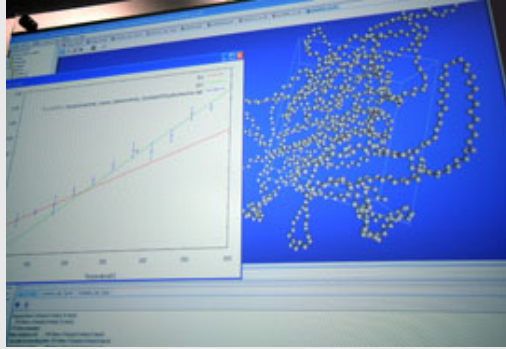
画面左は、樹脂のガラス転移温度を示すグラフ。 右は、樹脂を形成する高分子の構造。 分子の入れ換えや、拡大・縮小、回転などの操作を気軽に行うことができる。
