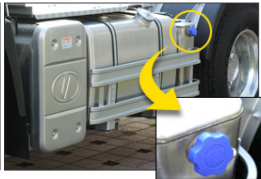
軽油タンクのとなりにあるAdBlueタンク。軽油の給油口と間違えないように、口の色や大きさを変えてある。
