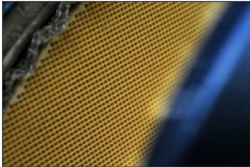
還元装置の内部。接触面積を増やし反応効率を上げるため網目構造になっている。 網目構造の表面でNO x が除去される。
